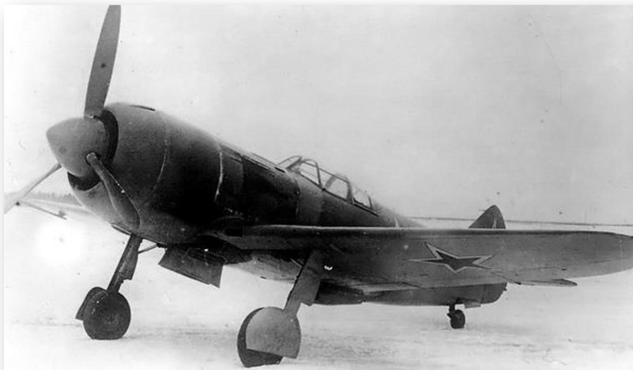
Истребитель, представлявший собой адаптацию ЛаГГ-3 под двигатель воздушного охлаждения М-82. Проработки подобной модификации велись ещё с конца 1940 г. Летом 1941 г. под руководством М.И. Гудкова на заводе № 21 (г. Горький) был построен самолет Гу-82, а в начале 1942 г. на заводе № 31, эвакуированном в Тбилиси - самолет ЛаГ-5, спроектированный М.П. Горбуновым. Однако в серию внедрили третий вариант ЛаГГ-3 с М-82, разработанный под руководством С.А. Лавочкина.
