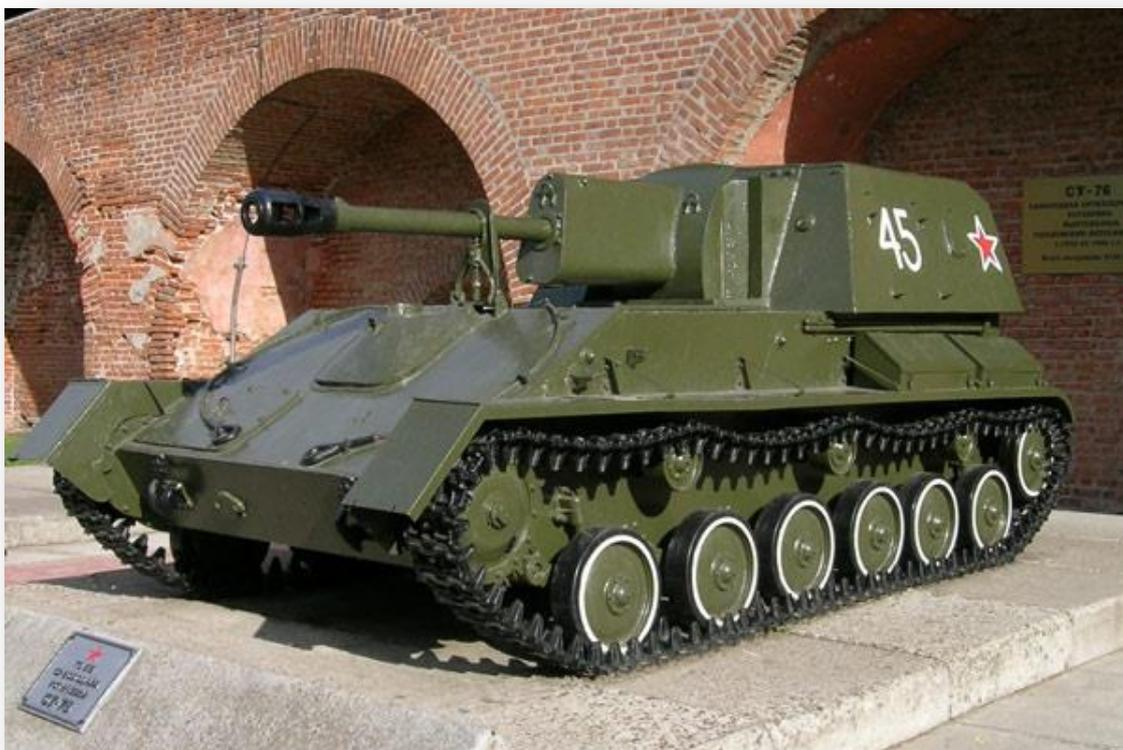
Осенью 1942 г. на базе танка Т-70 была разработана легкая самоходная артиллерийская установка под заводской маркой СУ-12. 9 декабря того же года состоялось правительственное испытание машины. Самоходная установка получила армейское наименование СУ-76 и была принята на вооружение Красной Армии. В январе 1943 г. началось серийное производство самоходных установок. Машина была предназначена для поддержки
