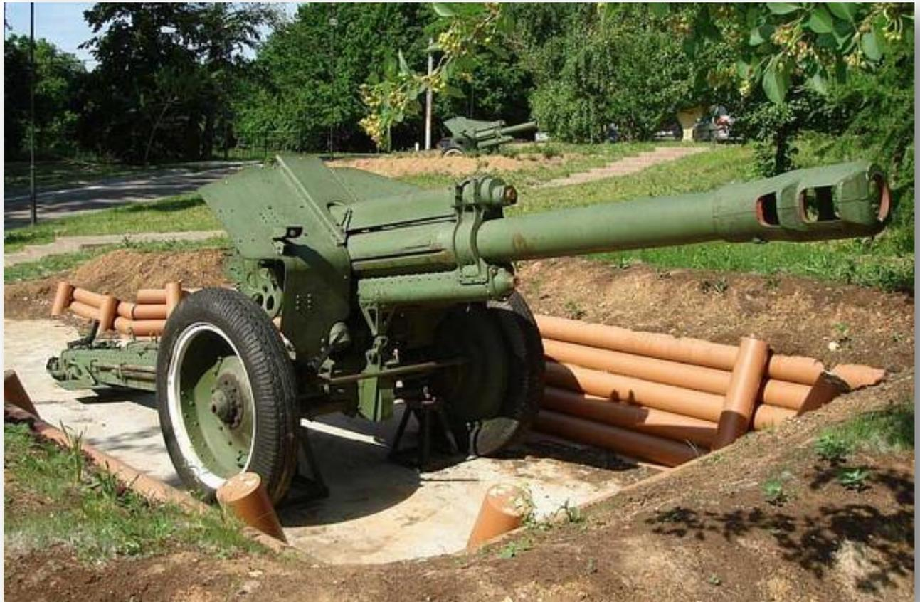
155-мм гаубицу Д-1 (в действительности ее калибр равен 152,4 мм) часто называют гаубицей образца 1943 года, так как именно в этом году она была принята на вооружение Красной Армией. Разработанная в спешном порядке в военные годы плодотворным конструкторским бюро под руководством Петрова. Гаубица Д-1 продолжает распространенную советскую традицию сочетания компонентов различных артиллерийских систем.
