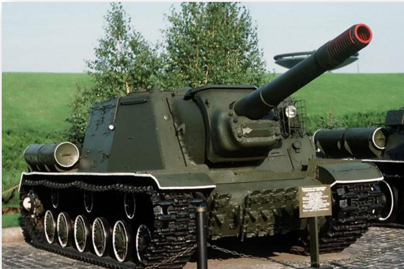
Разработка более крупного истребителя танков, вооруженного 152-мм орудием МЛ-20, стала прямым ответом на появление у немцев во время боев у осажденного Ленинграда в январе 1943 года танка «Тигр». В течение всего 1942 года две бригады конструкторов Центрального конструкторского бюро (ЦКБ-2) под руководством ветерана подполковника Котина (он отвечал за разработку танка КВ) работали над созданием нового тяжелого танка, предназначенного для замены устаревающего КВ-1.
